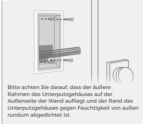
Bitte achten Sie darauf, dass der äußere Rahmen des Unterputzgehäuses auf der Außenseite der Wand aufliegt und der Rand des Unterputzgehäuses gegen Feuchtigkeit von außen rundum abgedichtet ist.
