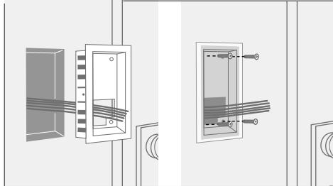
Veuillez vous assurer que le cadre extérieur du boîtier encastré repose sur l'extérieur du mur et que le bord du boîtier encastré est scellé tout autour afin d'éviter l'humidité de l'extérieur. Vissez le support mural du boîtier de montage au mur.
