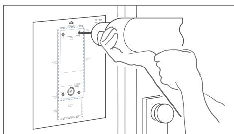
Wenn die Hauswand nicht aus Holz besteht, bohren Sie gemäß der Bohrschablone Dübellöcher mit einem Durchmesser von 5 mm in die Wand und setzen Sie die mitgelieferten Dübel ein.
