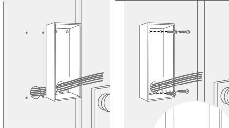
Avant le montage : percez le centre de l'obturateur en caoutchouc à l'aide d'un tournevis pour y passer les câbles.
