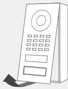
Extraiga la placa frontal con la unidad principal eléctrica de la carcasa trasera de montaje.
