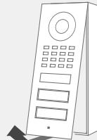
Ziehen Sie die Frontplatte mit der elektrischen Haupteinheit aus dem Gehäuse heraus.
