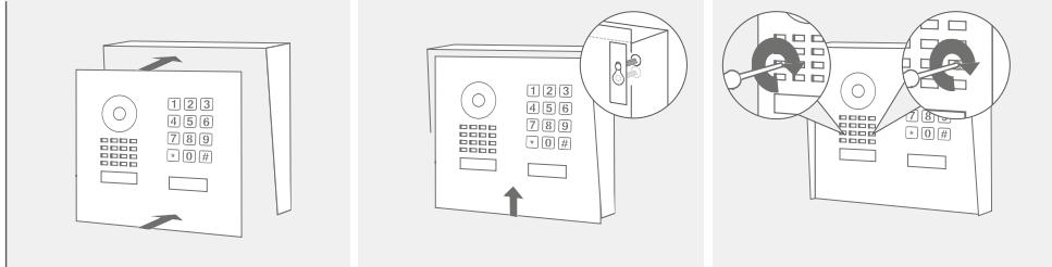
**NOTICE** Ziehen Sie die Sicherheitsschrauben nur von Hand an (weniger als 5 Newtonmeter[Nm]), da sonst das Gehäuse der Hauptelektronik beschädigt werden kann.
