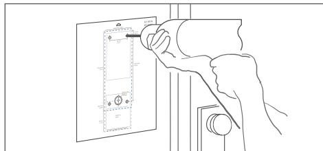
Si le mur de la maison n'est pas en bois, vous devez percer des trous de 5 mm (0.19 in) de diamètre dans le mur selon le gabarit de perçage, puis placer les chevilles fournies dans les trous.
