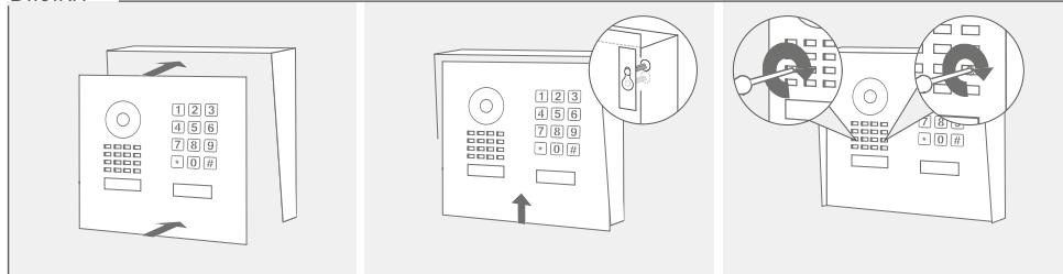
**NOTICE** Apriete los tornillos de seguridad, pero solo a mano (menos de 5 newtons metro [Nm]) ya que, de lo contrario, se podría dañar la carcasa de la electrónica principal.
