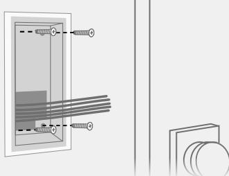
Asegúrese de que el marco exterior de la carcasa empotrada se encuentre en la parte exterior de la pared y de que el marco de la carcasa empotrada quede totalmente sellado por fuera contra la humedad.
