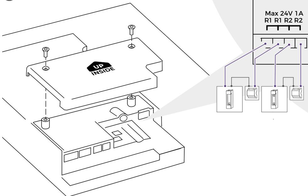
Il dispositivo è dotato di apposite prese contrassegnate che consentono il collegamento comodo e sicuro di cavi e fili. A questo punto si possono collegare al dispositivo tutti i cavi e fili necessari. Rimuovere i cavi e i fili non necessari dalle rispettive prese del dispositivo. Rimuovere circa 5 mm di isolamento dall'estremità dei fili da collegare alla morsetteria a vite verde.
