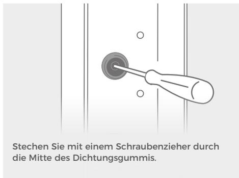
Stechen Sie mit einem Schraubenzieher durch die Mitte des Dichtungsgummis.
