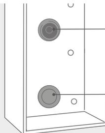
Dichtungsgummi für die Kabeldurchführung
