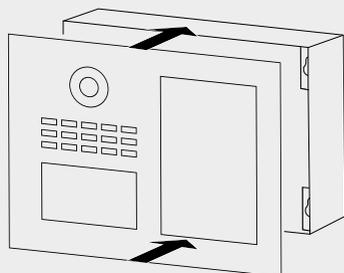
Inserire il pannello frontale nell'alloggiamento posteriore.
