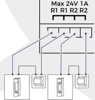
Das Gerät verfügt für ein komfortables und sicheres Anschließen der Kabel und Drähte über beschriftete Anschlussbuchsen. Sie können jetzt alle erforderlichen Kabel und Drähte mit dem Gerät verbinden. Entfernen Sie bitte die Kabel und Drähte von den Anschlussbuchsen des Geräts, die Sie nicht benötigen. Entfernen Sie etwa 5 mm der Isolierung am Ende der Drähte, die Sie an den grünen Schraubklemmenblock anschließen möchten.
