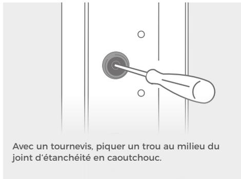
Avec un tournevis, piquer un trou au milieu du joint d'étanchéité en caoutchouc.
