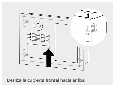
Desliza la cubierta frontal hacia arriba.
