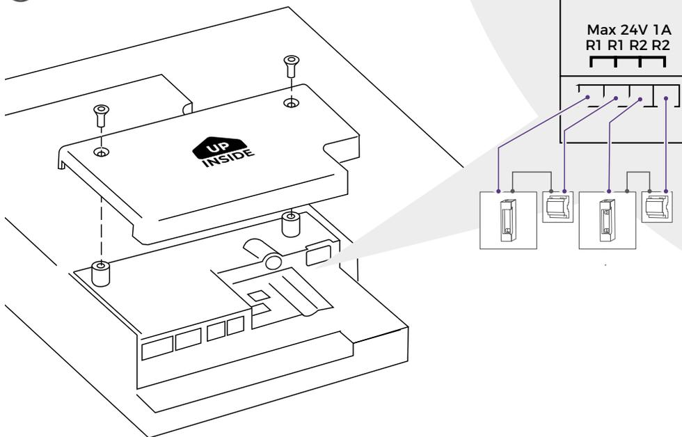
L'appareil est doté d'un mode de connexion confortable et sûr des câbles et fils grâce aux ports de connexion repérés par inscription. Vous pouvez maintenant raccorder à l'appareil tous les câbles et fils requis. Veuillez retirer des ports de connexion de l'appareil les câbles et fils dont vous n'avez pas besoin. Retirez environ 5 mm d'isolation au bout des fils que vous souhaitez raccorder au bornier à vis vert.
