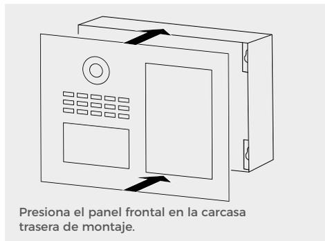
Presiona el panel frontal en la carcasa trasera de montaje.
